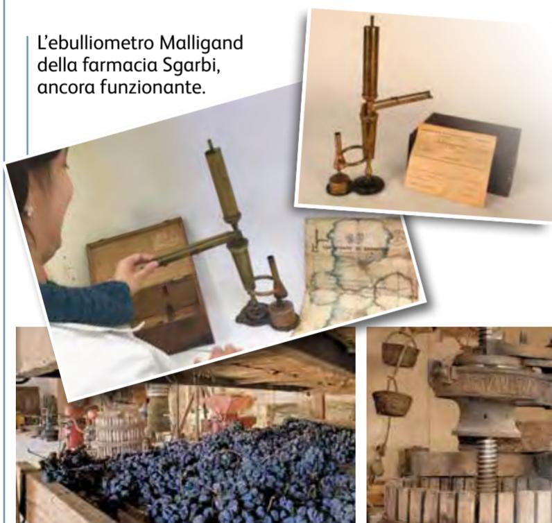
In farmacia negli anni '60 si misurava il grado alcolico delle bevande, tipicamente del vino, utilizzando l'ebullimetro Malligand, realizzato in ottone, rame e legno.
